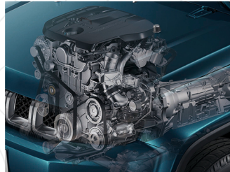
4 CYL DOHC 2.0 LTR TURBO 221 HP 380 NM TORQUE
